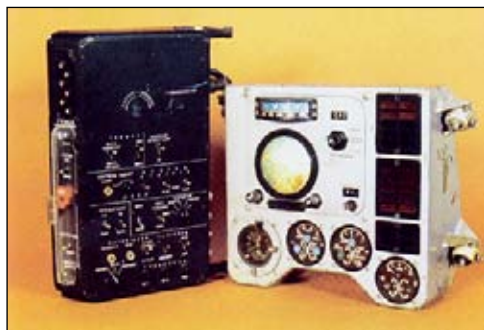
Пульт управления и приборная доска корабля «Восток».
